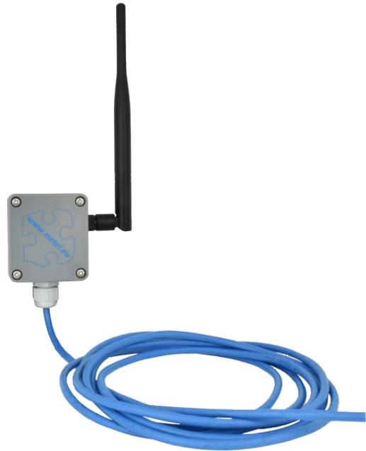
I moduli finali LoRaWAN EP1 sono adatti per applicazioni con trasmissione di valori da sensori collegati al PLC IPLOG GAMA. Il sistema non è quindi limitato a soli 1-2 valori, come di consueto, ma consente la trasmissione di valori da decine di sensori contemporaneamente.
