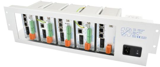
I rack SHELF-3U/IP-SU da 19" sono progettati per il montaggio rapido e professionale di switch industriali e media converter LAN-RING in rack da 19". Sono incluse guide per consentire la rimozione parziale o completa del ripiano dal rack da 19".
